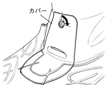
2. オイルタンクキャップを外し、エンジンオイルを補給します。
