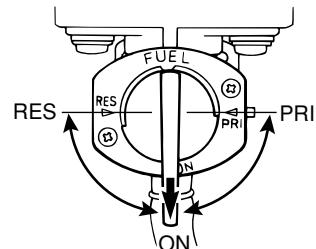
この車のフューエルコックは自動コックです。ONおよびRESの位置でエンジンが停止すると、自動的にガソリンの流れが止まります。
