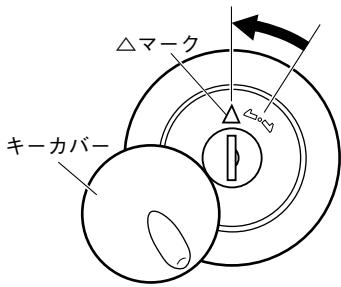
5. キーを反時計方向に回して抜き、キー カバーを閉めます。
