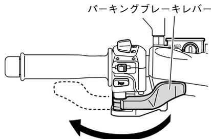
料金所などでの一時停車や、両手を離れた状態で車両を停車するときなどに使用します。パーキングブレーキレバーを左方向へ倒すと後輪がロックされます。パーキングブレーキの解除は、パーキングブレーキレバーを右方向へ戻します。
