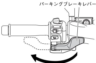
料金所などでの一時停車や、両手を離した状態で車両を停車するときなどに使用します。パーキングブレーキレバーを左方向へ倒すと後輪がロックされます。パーキングブレーキの解除は、パーキングブレーキレバーを右方向へ戻します。
