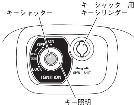
メインスイッチのキー孔をガードします。キーシャッターの開閉は、付属のリモコンで行います。また、キーを使って開閉することもできます。
