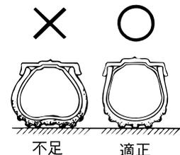
タイヤ接地部のたわみ状態により空気圧が不足していないかを点検します。たわみ状態が異常なときは、タイヤゲージで点検し、正規の空気圧にしてください。空気圧はタイヤの冷えているときに測定してください。
