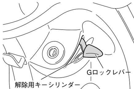
Gロックはメインスイッチのキー孔をガードし、後輪をロックします。
