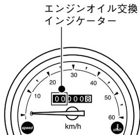
エンジンオイルの交換時期を示します。オドメーターの5桁目の文字（×1,000kmを表示する文字）の色と、6桁目の文字（×10,000kmを表示する文字）の色が揃ったときに交換時期の目安です。
