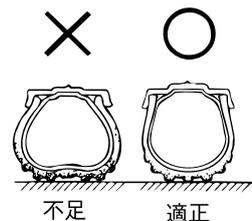
タイヤ接地部のたわみ状態により空気圧が不足していないかを点検します。たわみ状態が異常なときは、タイヤゲージで点検し、正規の空気圧にしてください。この車はチューブレスタイヤを装着してあります。
