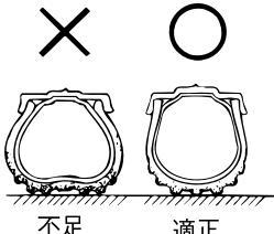
タイヤ接地部のたわみ状態により空気圧が不足していないかを点検します。たわみ状態が異常なときは、タイヤゲージで点検し、正规の空気圧にしてください。
