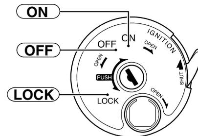
メインスイッチはエンジンの始動と停止、ブレーキランプや方向指示灯などの電源の「入/切」、ハンドルロック、シートのロック解除を行います。
