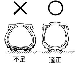
タイヤ接地部のたわみ状態により空気圧が不足していないかを点検します。たわみ状態が異常なときは、タイヤゲージで点検し、正規の空気圧にしてください。
