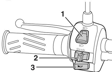
1. ヘッドライト上下切り替えスイッチ “ $\equiv\bigcirc/\bigcirc\equiv$ ”
