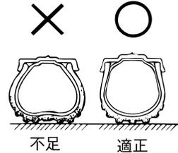
タイヤ接地部のたわみ状態により空気圧が
