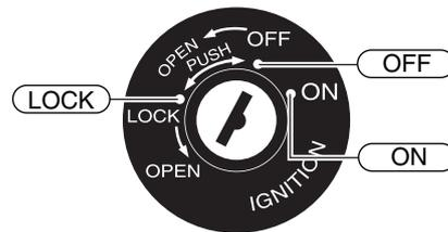
メインスイッチはエンジンの始動と停止、ブレーキランプや方向指示灯などの電源の「入/切」、ハンドルロック、シートのロック解除を行います。
