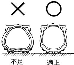
タイヤ接地部のたわみ状態により空気圧が不足していないかを点検します。たわみ状態が異常なときは、タイヤゲージで点検し、正規の空気圧にしてください。
