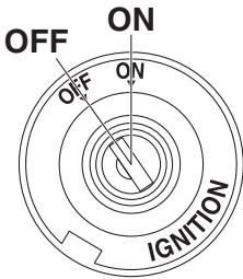
メインスイッチはエンジンの始動と停止、ブレーキランプや方向指示灯などの電源の「入 / 切」を行います。
