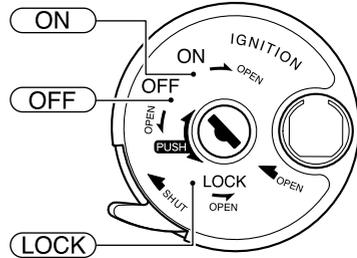
メインスイッチはエンジンの始動と停止、ブレーキランプや方向指示灯などの電源の「入/切」、ハンドルロック、シートのロック解除を行います。
