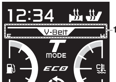
1. V ベルト交換表示 “V-BELT”
