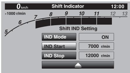
5. ホイールスイッチを回し、インジケーターが点灯する回転数 (r/min) を設定します。“IND Start”の設定可能範囲は、5000–12800 r/min の間です。
