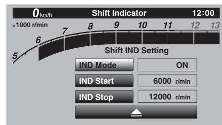
3. 設定したエンジン回転数に達したとき、インジケーターを常時点灯にするには“ON”を、消灯とするには“OFF”を、点滅させるには“Flash”を選択します。
