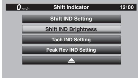
“Shift IND Brightness”を選択し、ホイールスイッチを用いて設定を調整します。短押しして設定を確定し、終了します。
