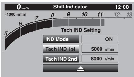
5. 始点(r/min)をホイールスイッチを回して調整し、短押しします。設定した値(r/min)から“Tach IND 2nd”における設定値(もしくはレッドゾーンまで)が、自動的に緑色で表示されます。
