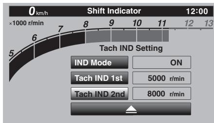
7. オレンジ色表示の始点(r/min)をホイールスイッチを回して調整し、短押しします。設定した値(r/min)からレッドゾーンまでが、オレンジ色で表示されます。
