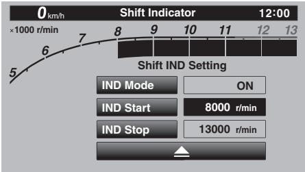
6. “IND Stop”を選択し、ホイールスイッチを回してインジケーターランプが消灯する回転数 (r/min) を設定します。“IND Stop”的設定可能範囲は、5500–13000 r/min の間です。
