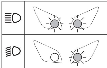
ヘッドライトの配光が下向きのときに“PASS”側を押すと、ヘッドライトの上向きも点灯します。先行車の追い越しなどで、他車に合図をするときに使用します。
