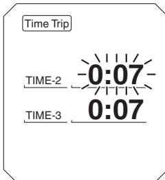
3. 選択した項目が点滅している間に、“RESET” を 2 秒以上押します。
