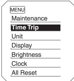
2. メニュースイッチ “MENU” を押して、“TIME-2” および “TIME-3” を表示させます。タイムトリップをリセットするには、“RESET” ボタンを押してリセットする項目を選択します。
