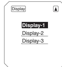
3. セレクトスイッチを使用して変更する項目を反転表示させてから、メニュー スイッチ “MENU” を押します。
