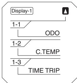
6. セレクトスイッチを使用して “▲” を反転表示させてから、メニュー・スイッチ “MENU” を押して、設定モードメニューに戻します。
