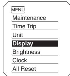
2. メニュー スイッチ “MENU” を押し、セレクトスイッチを使用して変更する表示を反転表示させてから、メニュー スイッチ “MENU” を再度押します。
