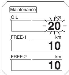
3. 選択した項目が点滅している間に、“RESET” を 2 秒以上押します。
