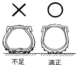
6 タイヤ接地部のたわみ状態により空気圧が不足していないかを点検します。たわみ状態が異常なときは、タイヤゲージで点検し、正規の空気圧にしてください。空気圧はタイヤが冷えているときに測定してください。この車はチューブレスタイヤを装着しています。
