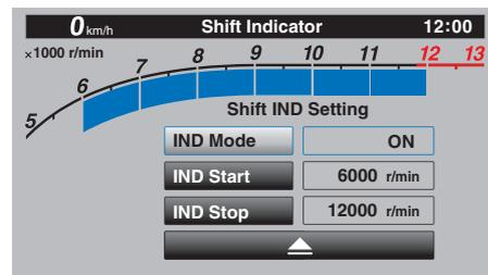
3. 設定したエンジン回転数に達したとき、インジケータを常時点灯にするには“ON”を、消灯するには“OFF”を、点滅させるには“Flash”を選択します。
