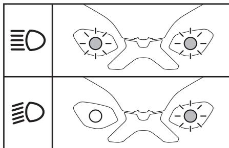
ヘッドライトの配光が下向きのとときに“PASS”側を押すと、ヘッドライトの上向きも点灯します。先行車の追い越しなどで、他車に合図をするとき使用します。
