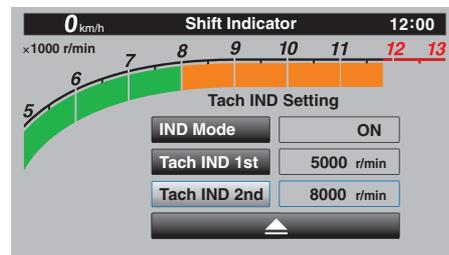
6. オレンジ色表示の始点 (r/min) をホイールスイッチを回して調整し、短押しします。設定した値 (r/min) からレッドゾーン 11800 r/min までが、オレンジ色で表示されます。
