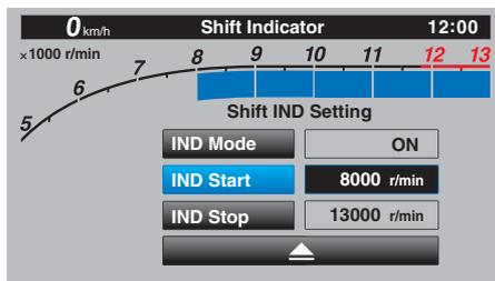
6. “IND Stop” を選択し、ホイールスイッチを回してインジケータランプが消灯する回転数 (r/min) を設定します。“IND Stop” の設定可能レンジは、5500–13000 r/min の間です。
