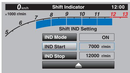
5. ホイールスイッチを回し、インジケータランプが点灯する回転数 (r/min) を設定します。“IND Start” の設定可能レンジは、5000–12800 r/min の間です。
