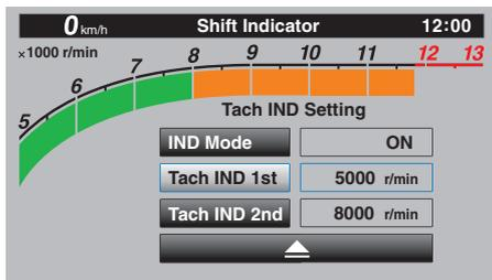
4. 始点 (r/min) をホイールスイッチを回して調整し、短押しします。設定した値 (r/min) から “Tach IND 2nd” における設定値 (もしくはレッドゾーン 11800 r/min まで) が、自動的に緑色で表示されます。
