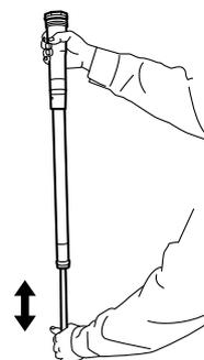
10. ウェスなどでダンパー Ass'y “1” を保護して最圧状態にし、余分なオイルをベースバルブ側にオーバーフローさせます。
