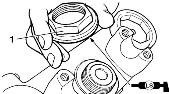
9. ナットを締め付けた後、ステアリングがスムーズに作動するか確認します。スムーズに作動しない場合は、ステアリングリングナットを徐々に緩めながらステアリングを調整します。
