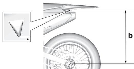
3. “a”の測定寸法値から“b”の沈下寸法値を引いた数値が基準値になるようにロックナット“1”を緩め、アジャスター“2”を回して調整してください。
