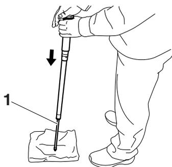
11. オーバーフローしたオイルをダンパー Ass'y の孔 “a” から排出します。
