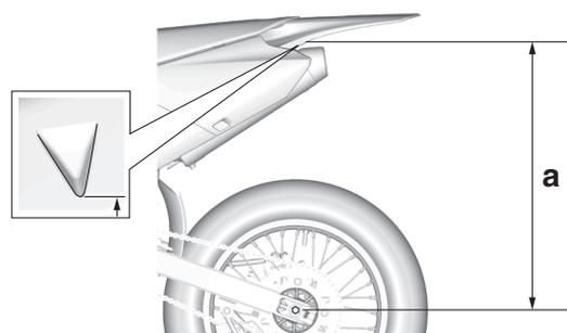
2. 車体をスタンドから降し、ライダーが乗車した状態でリヤホイールアクスルの中心とリヤフェンダーの“△”マーク間の沈下寸法“b”を測定してください。
