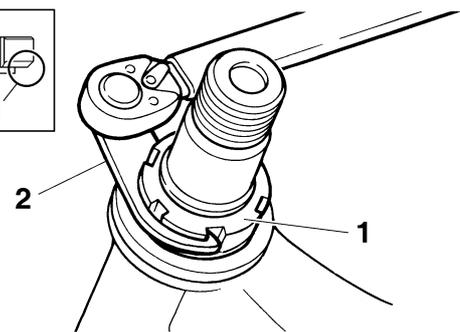
5. ステアリングシステムはロックからロックまで回して点検します。スムーズに回転しない場合は、ステアリングシステムを取り外し、ステアリングベアリングを点検します。
