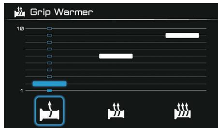
グリップウォーマーには 3 つの温度設定があり、それぞれの設定温度を調節できます。ジョイスティックを左右に操作して温度設定を選択し、ジョイスティックを上下に操作して温度レベルを 1-10 段階で調整します。“✓”を短押しして設定を確認し、前のメニューに戻ります。
