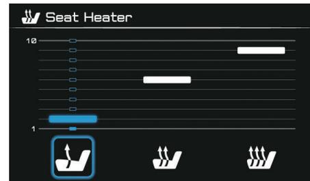
シートヒーターには 3 つの温度設定があり、それぞれの設定温度を調節できます。ジョイスティックを左右に操作して温度設定を選択し、ジョイスティックを上下に操作して温度レベルを 1-10 段階で調整します。“✓”を短押しして設定を確認し、前のメニューに戻ります。
