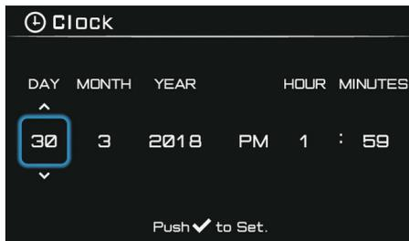
時計を手動で調整するには、ジョイスティックを左右に操作して項目を選択し、ジョイスティックを上下に操作して項目を調整します。“✓” を短押しすると、時計が設定され、前のメニューに戻ります。
