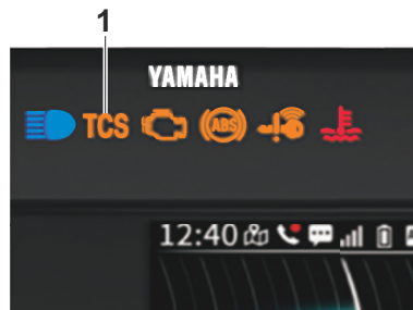
1. トラクションコントロールシステム表示灯 “TCS”
