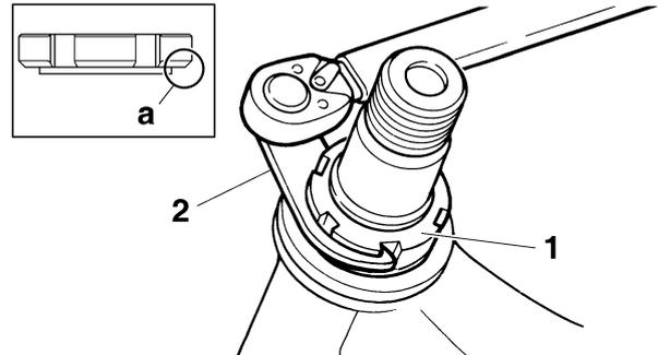
5. ステアリングステムはロックからロックまで回して点検します。スムーズに回転しない場合は、ステアリングステムを取り外し、ステアリングベアリングを点検します。
