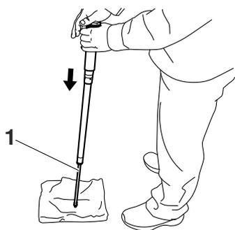
11. オーバーフローしたオイルをダンパー Ass'y の孔 "a" から排出します。
