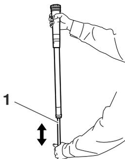
10. ウェスなどでダンパー Ass'y "1" を保護して最圧状態にし、余分なオイルをベースバルブ側にオーバーフローさせます。
