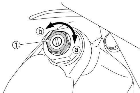
圧側減衰力（低速沈み込み時）
