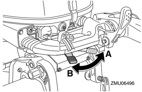
調整レバーを左舷側 “A” に回しても抵抗が増えない場合は、ナットを規定トルクで締め付けます。
