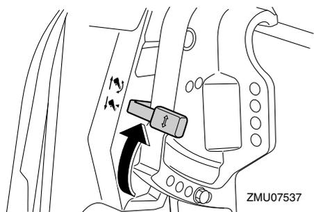
3. トップカウルの後部を持ち、チルトアップして適当な位置を保持したままチルトロックレバーをロックの位置へ戻します。この状態で浅瀬航走ができます。
