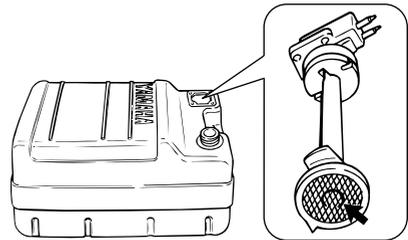
3. フィルター（サクションパイプの端に装着）を洗浄し、乾燥させます。
