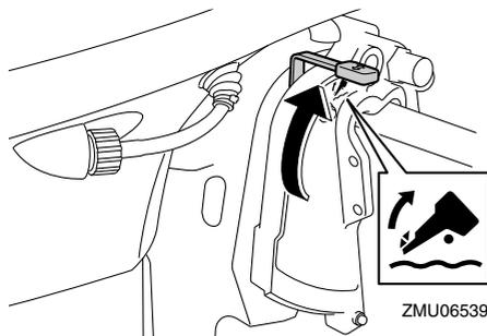
3. トップカウルの後部を持ち、チルトサポートバーが自動的にロックするまで船外機を少しチルトアップさせます。この状態で浅瀬航走ができます。この船外機は、2 箇所の浅瀬航走の位置が選ば
