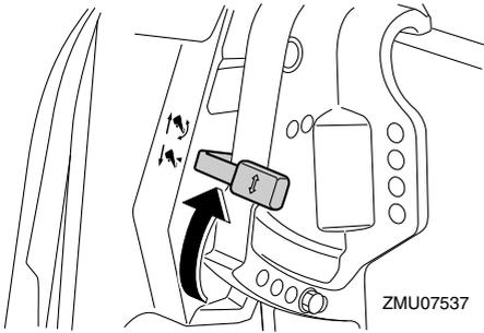
3. 片手でトップカウルの後部を持ち、トリム角度を適正な位置に調整します。
