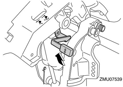
2. 片手でトップカウルの後部を持ち、少しチルトアップした状態でチルトサポートノブを引きだします。又は、チルトサポートレバーを元の位置に戻します。
