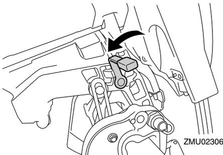
2. チルトサポートバーが自動的にクランプブラケット内側の溝から外れるまで少しチルトアップします。
