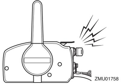
オーバーヒート警報が作動した場合は、エンジンを停止して冷却水取入口を点検してください。
