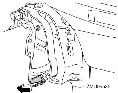
トリム角度を変えて試走を行ない、ボートの種類や使用状況に合わせて最適な位置を選んでください。
