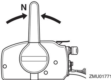
船には、停船装置がありません。シフト中立（ニュートラル）操作後、エンジン回転数減少に伴う水の抵抗により停船します。停船距離は、総重量、水面の状態、風向によって異なります。
