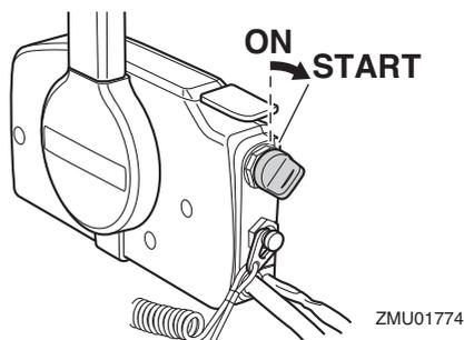
5. 始動後はただちにスイッチを“ON”の位置にします。**注意**：スターターモーターは、連続して5秒以上回さないでください。スターターモーターを5秒以上連続して回すと、バッテリーが上がりエンジンが始動できなくなる恐れがあります。5秒以内でエンジンが始動しない時は、10秒たってからもう一度行なってください。エンジン運転中は、エンジンスイッチを“START”の位置にしないでください。[JCM00193]
