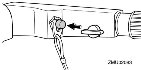
2. 燃料ホースコネクタがある場合、エンジン停止後に船外機から燃料ホースコネクタを外します。
