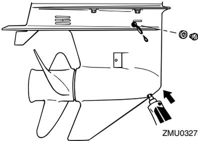
6. 注入したギヤオイルがオイルレベル穴から溢れ出したら、新しいガasketを取り付けたオイルレベルプラグを締めます。
