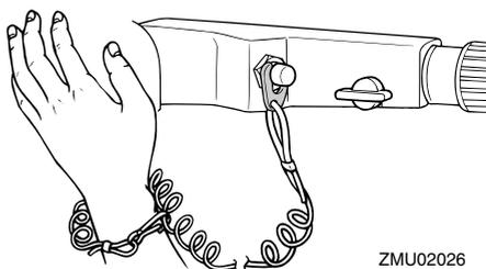
4. シフトを中立（ニュートラル）にして、エンジンシャットオフコードのロックプレートが緊急エンジン停止スイッチへ差し込みます。エンジンスイッチの装備されているものは、“ON” にします。
