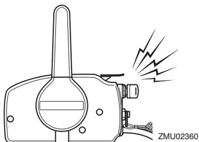
油圧低下警報が働いた場合は、ただちにエンジンを停止してください。エンジンオイルの量を点検し、必要な場合は補充します。適量のエンジンオイルが有るにもかかわらず警報装置が作動した場合には、ヤマハ取扱店で点検を受けてください。
