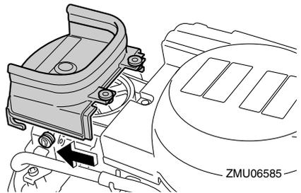
2. 10ピンコネクタが装備されている場合、クランプを外し10ピンコネクタをフライホイールマグネットカバーから外します。
